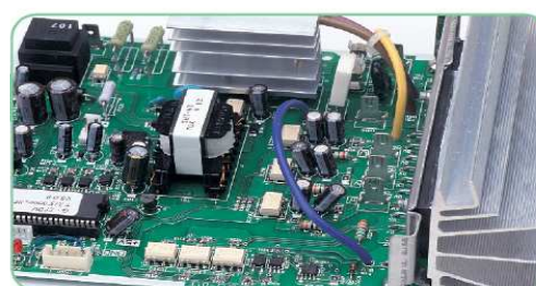
řídící jednotka Toshiba IDPU inverter
