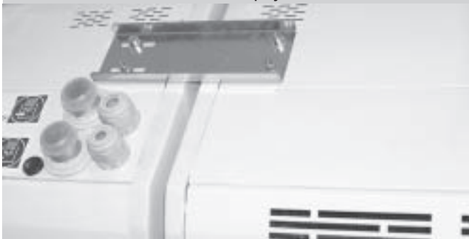
Obrázek 31 – mechanické spojení clon C1
